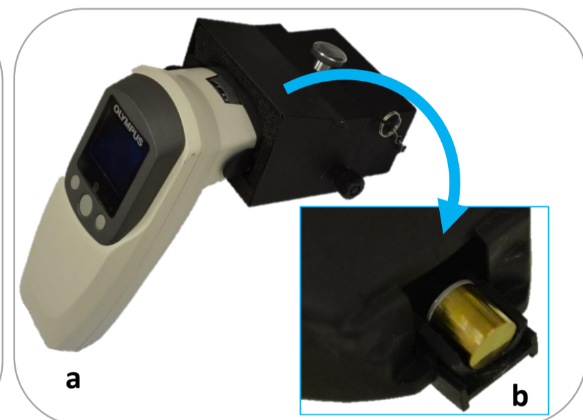
fig3.a分光光度計による測色, b測色時の試料の配置
